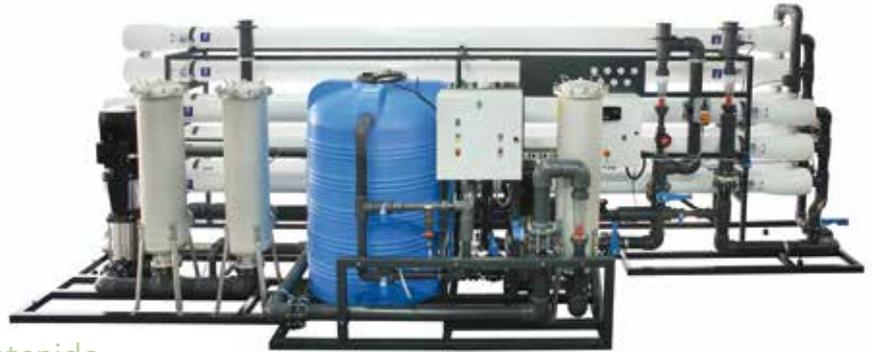
Equipos de ósmosis inversa de alta producción de agua con un bajo contenido en sales, donde se precise un volumen diario de agua tratada importante. Configuración adaptable según las necesidades.
