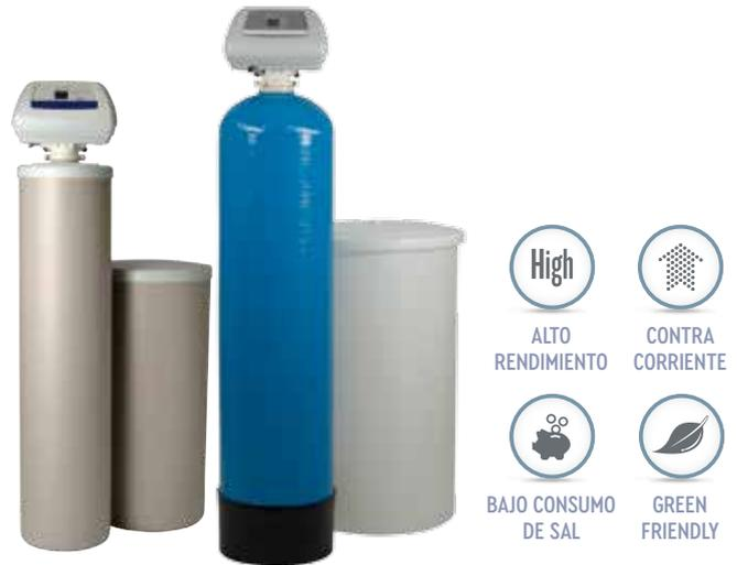
» Construcción bi-bloc con materiales anticorrosivos de excelente resistencia mecánica. Cuerpo construido en poliéster reforzado con fibra de vidrio bobinado y depósito de sal en polietileno de alta densidad rotomoldeado.
