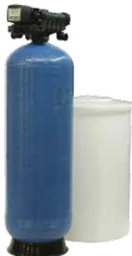
» Construcción bi-bloc. Botella construida en poliéster reforzado con fibra de vidrio. Liner interior en P.E. alimentario. Depósito salmuera en polietileno rotomoldeado con falso fondo.
